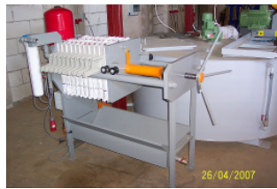
die Kammerfilterpresse mit Polzeifilter und Ölpumpe sowie eine Tankanlage mit 2.500 l Tank und Zapfpistole. Die gesamte Mühle benötigt einen Platz von ca. 6 x 8 m und eine Raumhöhe von ca. 5 m.
