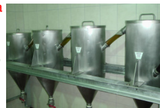
500 л промежуточный бункер 4x60 л седиментация из нержавеющей
