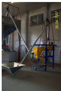
odbiór rzepaka oczyszczanie magnetyczny sortownik 2 przenośniki ślimakowe
